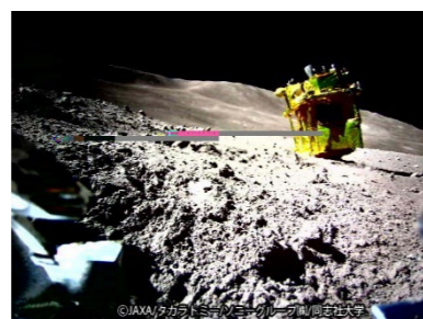
LEV-2「SORA-Q」が撮影・送信した月面画像 (クレジット: JAXA/タカラトミー/ソニーグループ(株)/同志社大学) この画像はLEV-1、LEV-2無線局の試験電波データ転送により取得した試験画像になります。
